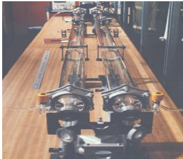
圖3 臭氧光度計光學結構（本圖片由NIST提供）
